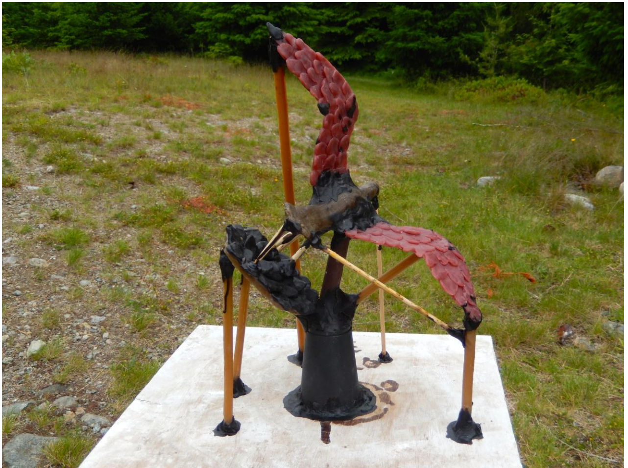
Gietkom (plastic beker), ontluchters en opkomers gemonteerd.( gietkom onderste boven )
