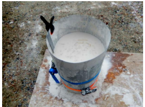
De vorm gevuld met de gips/chamotte massa
