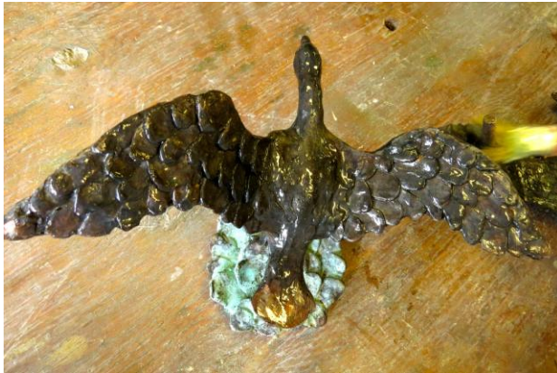
Patineren van het werkstuk met chemicaliën en brander
