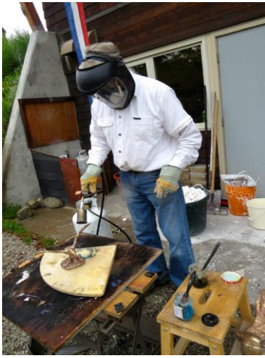
Patineren van het werkstuk met chemicaliën en brander
